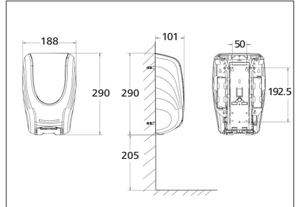
\* Bohrlöcher der CleanSafe-Spender Rückwände sind nicht identisch mit denen der bestehenden BODE Eurospender.
